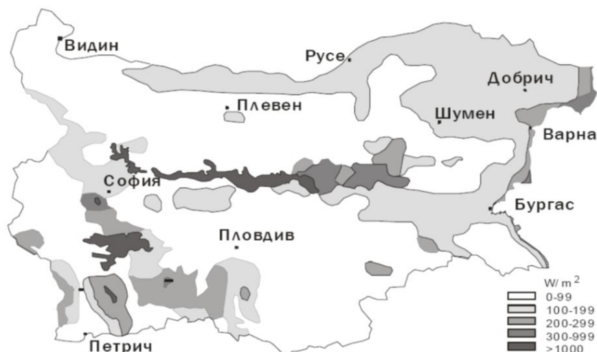
Фигура 2.6. Зони с различна плътност на мощността на вятъра в България
